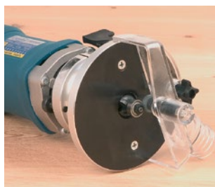
Conexión para la aspiración dotada de un freno para el rodamiento, que evita marcar el canto.
