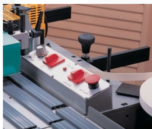
Regulación electrónica de la temperatura.
