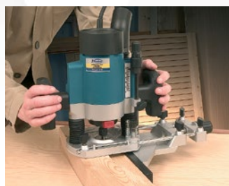
Gran precisión y estabilidad durante el fresado.
