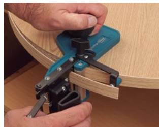
Retestado del sobrante en paneles circulares.
