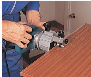
Perfilado de estratificados.
