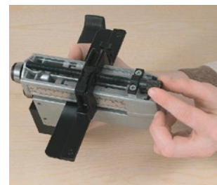
Ajuste micrométrico de la anchura de corte.
