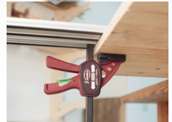
Incluye 2 sargentos que colocados en la guía inferior sujetan el riel incluso cuando éste sobresalga del panel.
