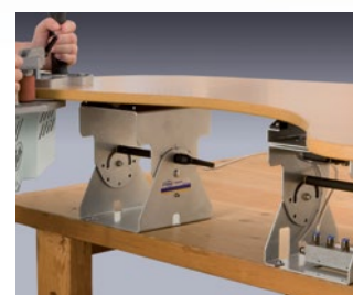
Sujeción de una pieza de grandes dimensiones con una unidad auxiliar SVN470
