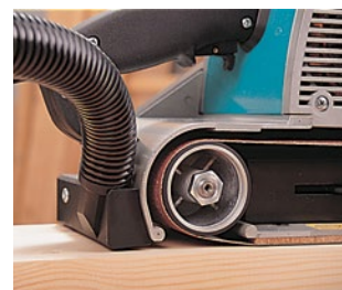
Equipado con toma para aspiración externa.
