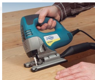
Base inclinable de 0° a 45°.
