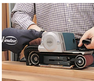
Mod. LB31EA con aspirador del polvo incorporado.
