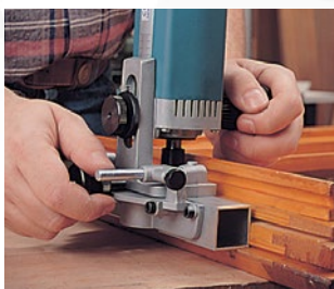
Ranurado de ventana por lado vierte aguas.
