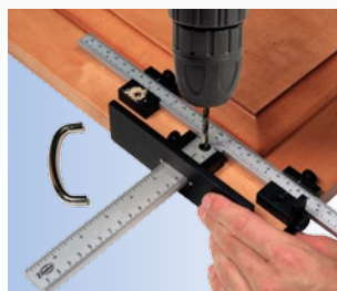
Taladrado para tiradores de puertas.
