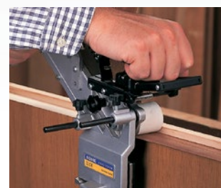
Aplacado de la cara interior de una puerta con solape.
