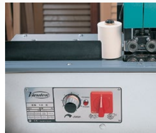
Regulación electrónica de la temperatura.
