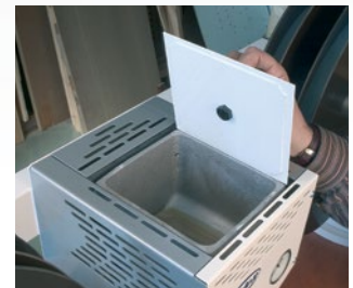
Depósito de cola de fácil acceso. Su sistema de aplicación de cola, incorpora un rodillo de silicona anti-adherente de muy fácil limpieza.
