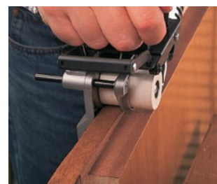
Aplacado de la cara superior del solape.
