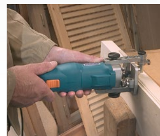
Realización de molduras.
