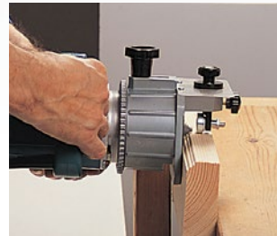
Realización de molduras.
