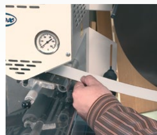
Pre-encolado de tiras sueltas.
